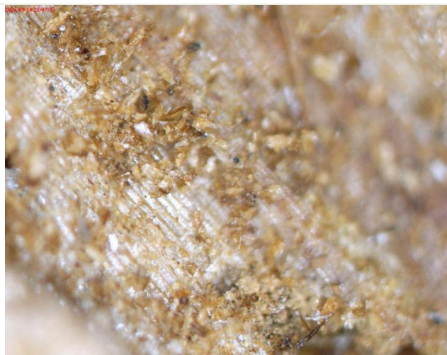
Zd. nr 42. Przykład spróchniałego drewna wraz z jego brunatnym rozkładem widocznym pod mikroskopem.
