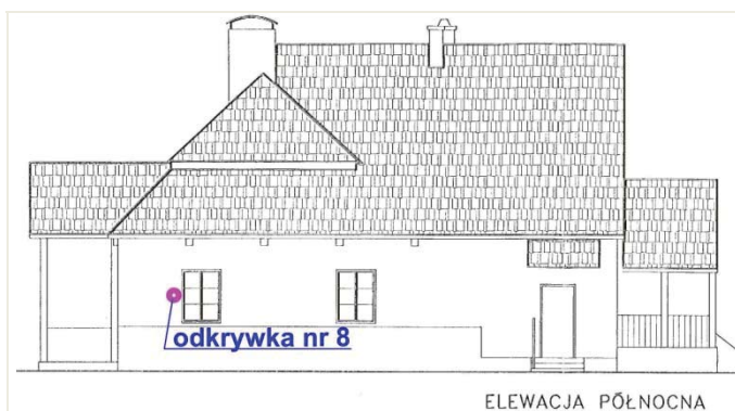
Zd. nr 43. Miejsce wykonanej odkrywki nr 8 od strony północnej budynku. zaznaczono kolorem różowym. na wysokości 205cm od powierzchni opaski kamiennej przy ścianie.
