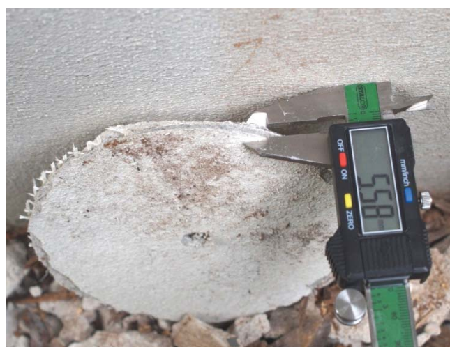
Zd.nr 14. Zbadano grubość tynku cienkowarstwowego, która wynosi 5,58 mm. Widoczna powłoka malarska oraz zatopiona siatka z tworzywa sztucznego.
