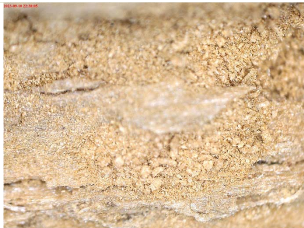
Zd.nr 30. Przykład spróchniałego drewna wraz z brunatnym rozkładem widocznym pod mikroskopem.
