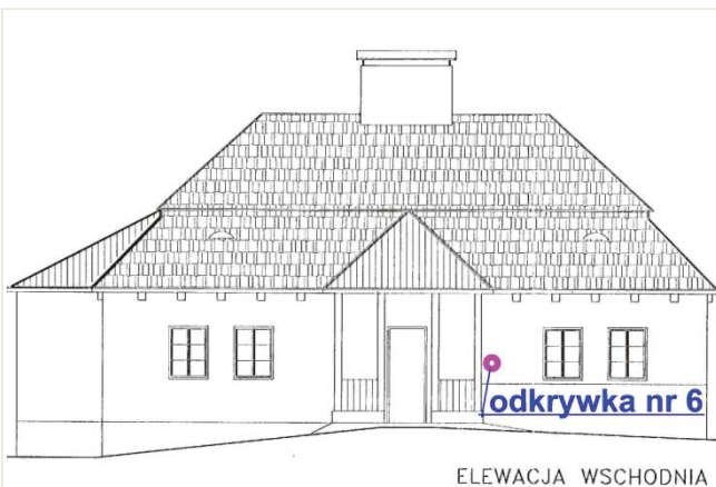
Zd. nr 31 .Miejsce wykonanej odkrywki nr 6 od strony wschodniej budynku zaznaczono kolorem różowym. na wysokości 65cm od powierzchni opaski kamiennej przy ścianie
