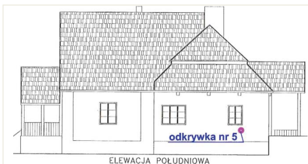
Zd. nr 25. Miejsce wykonanej odkrywki nr 5 od strony południowej budynku zaznaczono kolorem różowym. na wysokości 85cm od powierzchni opaski kamiennej przy ścianie.
