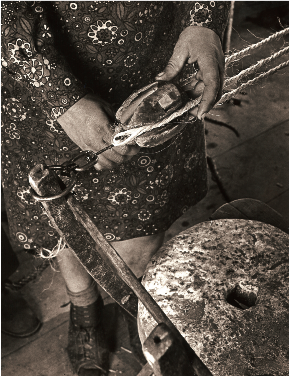
Ryc. 5. Mocowanie sznurków w wyźłobieniach „babki”. Końcówki „pokretek” składających się na powróż zaczepiono o „kulc”, osadzony na oparciu krzesła. Fot. J. Mąkowski.
