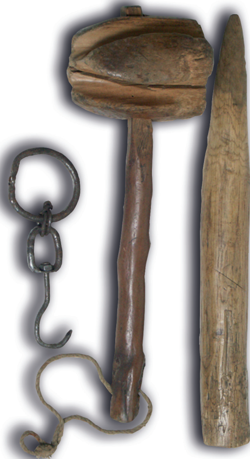
Ryc. 4. „Zestaw przyrządów pomocniczych z warsztatu powroźniczego w Leśnej Podkonarzu. Na fotografii kolejno od lewej: „kulę” do podczepiania sznurków; „babka” z uchwytem; „kołek do zarabiania pętełek”. Fot. K. Śędek.
