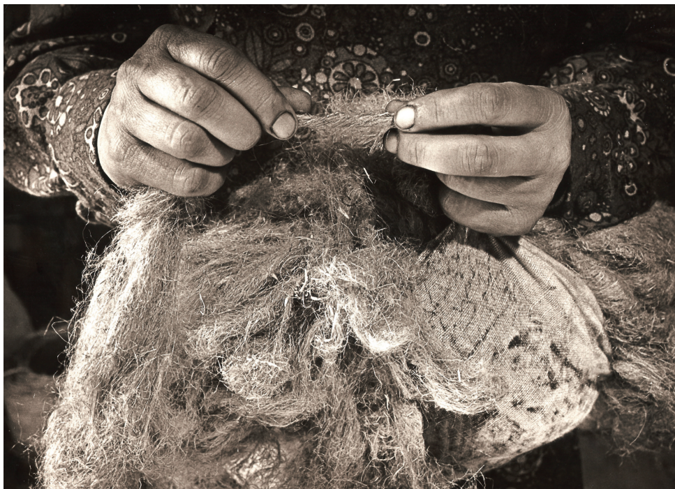
Ryc. 2. Snucie kądzieli konopnej z roztrzepanych „garstek” włókna. Warsztat Stanisława Łakomca, Leśna Podkonarze, gm. Bodzentyn. Fot. J. Mąkowski.
