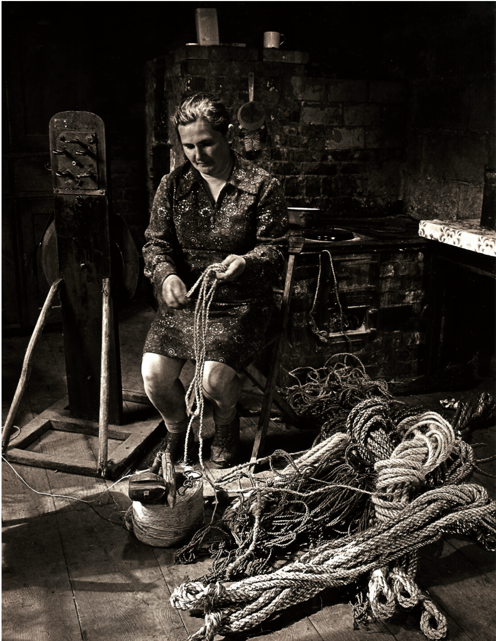
Ryc. 8. Wykańczanie i wiązanie gotowych wyrobów powroźniczych. Fot. J. Mąkowski.
